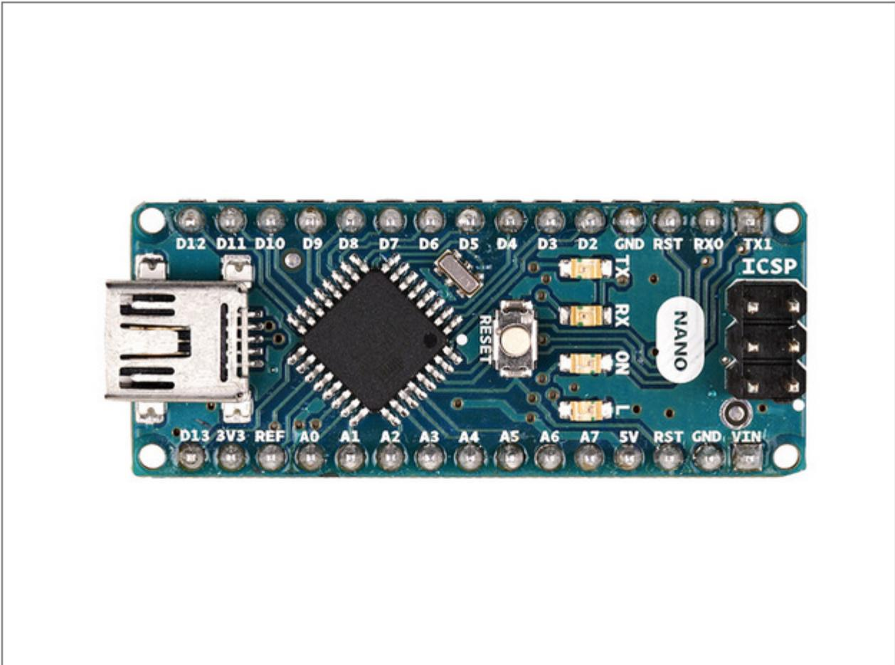
Arduino Nano è una scheda piccola e completa basata sull'ATmega328 (Arduino Nano 3.x). Ha più o meno la stessa funzionalità della Arduino Duemilanove, ma in una confezione diversa. Manca solo una presa di corrente continua e funziona con un cavo USB mini-B al posto di uno standard.
